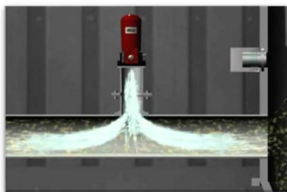
Figure 9-8 - Exemple de bouteille de suppression chimique sur un conduit (Source : Fike)
