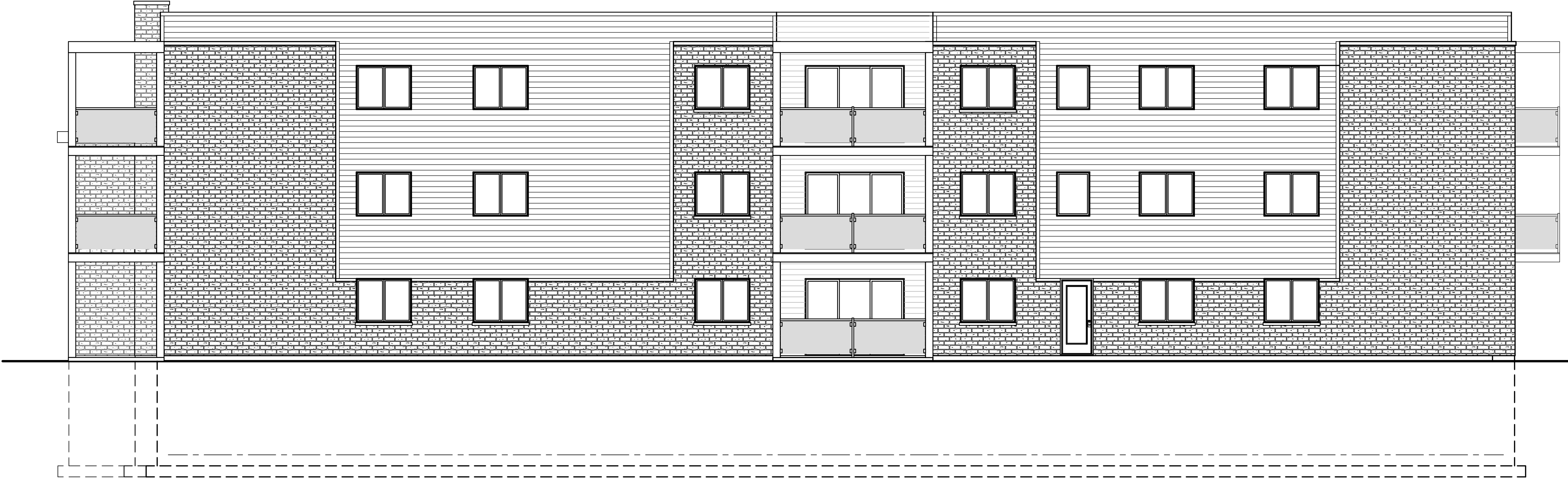
FAÇADE DE RAYONNEMENT, TABLEAU 9.10.14.4.-A DU CCQ2015 (CNB2015)
